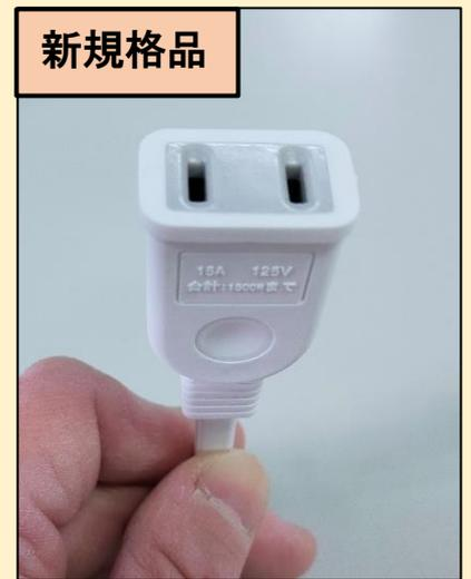
※ 再現実験では、旧規格の電源プラグは10分かからずトラッキング現象が発生し出火したのに対し、新規格の電源プラグは30分以上にわたり同様の状況を継続させても出火しませんでした。
