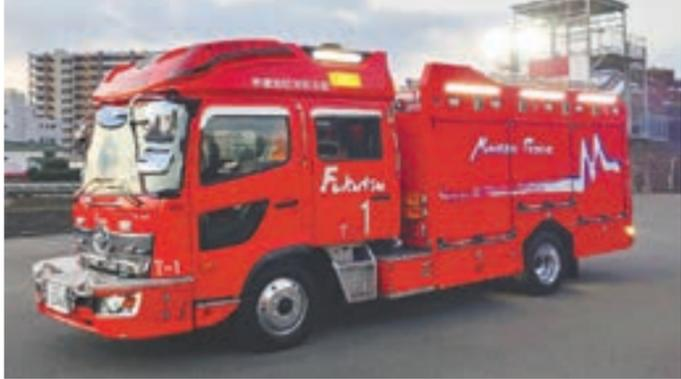
福津消防署に救助資機材を装備した水槽付き消防ポンプ自動車を配備し、令和2年1月16日から運用を始めています。今回配備した水槽付き消防ポンプ自動車には、1,400リットルの積載水に加えC A F S（圧縮空気泡消火装置）及び救助資機材を装備しており、火災現場、救助現場に対応できる仕様となっています。
