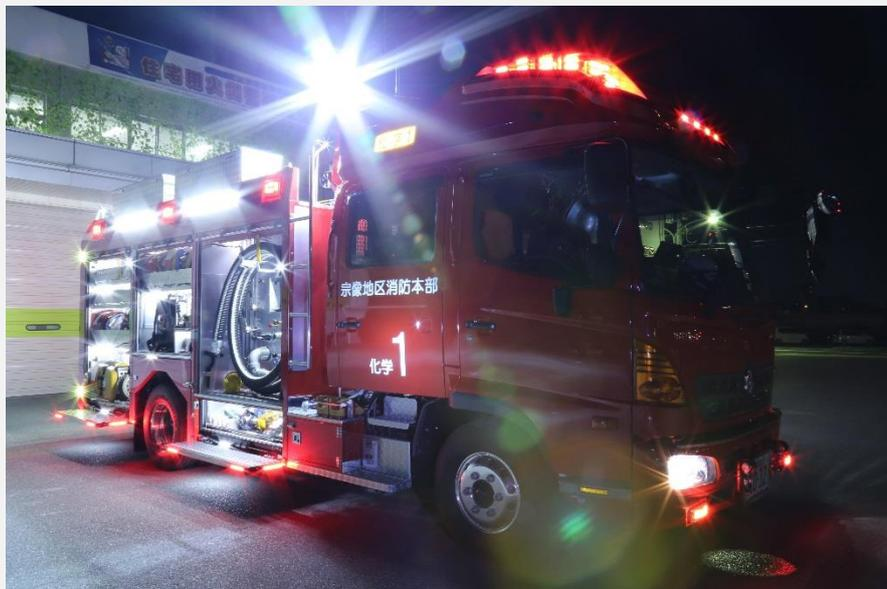
車両に搭載する照明器具等を全てLED化することにより、従来の照明器具等と比べ、大幅に省電力化することができ、それに伴って高輝度の照明器具及び車両の各部に埋め込まれた作業灯を数多く搭載することが出来ました。これにより、夜間の災害現場で活動する隊員の安全を確保し、必然的に災害活動の迅速化に繋がっています。
