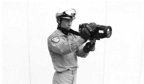
熱画像直視装置は、物体表面から自然放射されている赤外線を画像として、モニター上に表示するもので暗闇や濃い煙の中にとり残された人を発見したり、火元や残り火を確認するものです。
