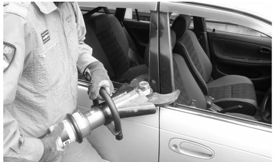
大型油圧式救助器具は、油圧ポンプとラムシリンダーを高圧ホースで接続したもので、ラムシリンダーに各種のアタッチメントを組み合わせ、取り付け、持ち上げ、広げ、押さえつけ、引っ張り、締めつけ、切断の操作ができ、交通事故などの人命救助や破壊工作などに使用されています。
