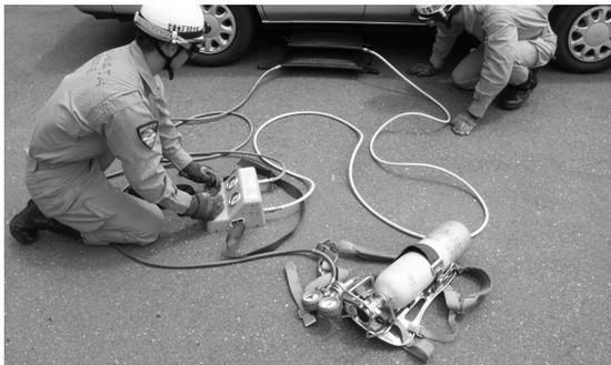
マット型空気ジャッキは、空気ポンプ、圧力調整器、ホース、調整器、バックで構成され、空気圧を利用して重量物の持ち上げ、変形したドアなどの開放に使用されます。
