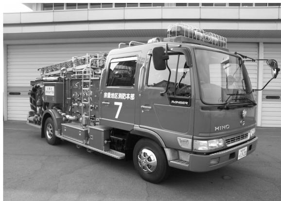
化学車は、主に油脂火災の消火活動を目的にした消防車で、1,300ℓの水と500ℓの泡消火薬剤を積載しています。
