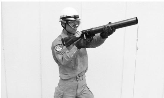
救命索発射銃は、高所、水面などの孤立した場所へ人命救助用ロープを展張したり、おぼれている人に対して着水後に膨脹浮上する救命用浮環を展張するためのもので、救助用ロープを目的の場所に誘導する救命索のついた発射体を発射する特殊な銃です。
