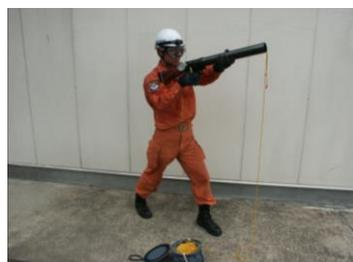
救命索発射銃は、高所、水面などの孤立した場所へ人命救助用ロープを展開したり、おぼれている人に対して着水後に膨張浮上する救命用浮環を展開するためのもので、救助用ロープを目的の場所に誘導する救命索のついた発射体を発射する特殊な銃です。
