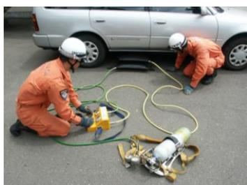
マット型空気ジャッキは、空気ポンプ、圧力調整器、ホース、調整器、バックで構成され、空気圧を利用して重量物の持ち上げ、変形したドアなどの開放に使用されます。
