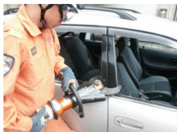
大型油圧式救助器具は、油圧ポンプを高圧ホースで各種のアタッチメント、持ち上げ、広げ、押さえつけ、引っ張り、締めつけ、切断の操作ができ、交通事故などの人命救助や破壊工作などに使用されています。
