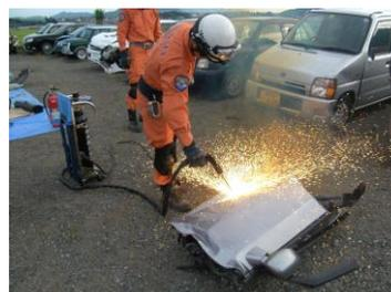
従来のガス切断器と異なり、アルミニウム、真ちゅう、ステンレスなどの各種金属や、スラブを素早く溶解切断することが出来る万能型の切断装置です。
