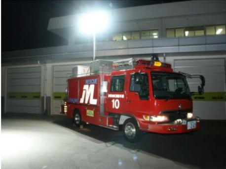
救助工作車は、火災救急等各種の災害現場で救助活動を目的にした消防車で、空気呼吸器やレスキューカッター・照明装置など各種救助資機材を積載しています。
