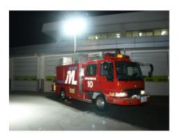
救助工作車は、火災救急等各種の災害現場で救助活動を目的にした消防車で、空気呼吸器やレスキューカッター・照明装置など各種救助資機材を積載しています。
