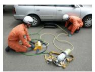
マット型空気ジャッキは、空気ボンベ、圧力調整器、ホース、調整器、バックで構成され、空気圧を利用して重量物を持ち上げ、変形したドアの開放などに使用されます。
