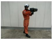
熱画像直視装置は、物体表面から自然放射されている赤外線を画像として、モニター上に表示するもので暗闇や濃い煙の中にとり残された人を発見したり、火元や残り火を確認するものです。
