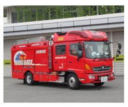
化学車は、主に油脂火災の消火活動を目的にした消防車で、1,500 ℓの水と500 ℓの泡消火薬剤を積載しています。
