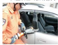
大型油圧式救助器具は、油圧ポンプと高圧ホースを用いて、各種アタッチメントに接続することで、持ち上げ、広げ、押さえつけ、引っ張り、締めつけ、切断の操作ができ、交通事故などの人命救助活動に使用されています。
