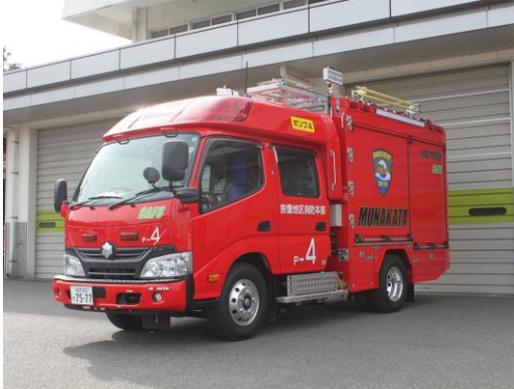
圧縮空気を利用し泡を生成する装置及び水600ℓを積載しており、少量の水で効率の良い泡消火を行います。
