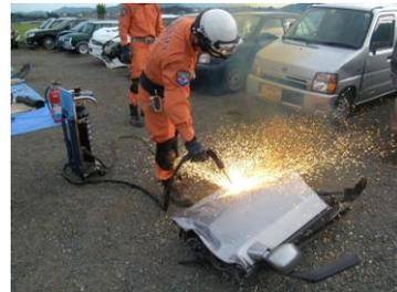
アルミニウム、真ちゅう、ステンレスなどの各種金属や、スラブを素早く溶解切断することができる万能型の切断器具です。
