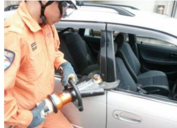
油圧ポンプと高圧ホースを用いて、各種アタッチメントに接続することで、持ち上げ、広げ、押さえつけ、引っ張り、締めつけ、切断の操作ができ、交通事故などの人命救助活動に使用します。
