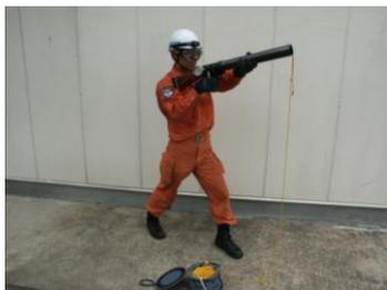
高所、水面などの孤立した場所へロープを展張したり、溺れている人に対して着水後に膨張浮上する救命用浮環を投入するためのもので、救命索のついた発射体を発射する特殊な銃です。
