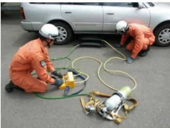
空気ポンプ、ホース、マット等を用いて、重量物の持ち上げや変形したドアの開放などに使用します。
