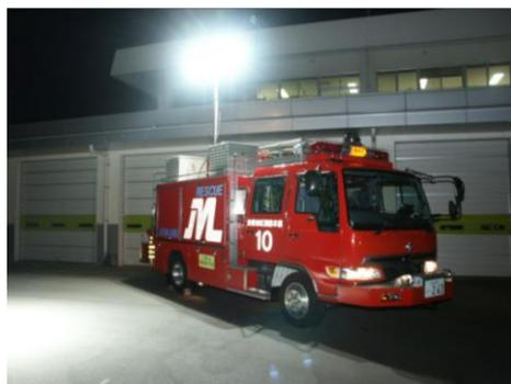
火災救急等各種の災害現場で救助活動を目的にした消防車で、空気呼吸器やレスキューカッター・照明装置など各種救助資機材を積載しています。
