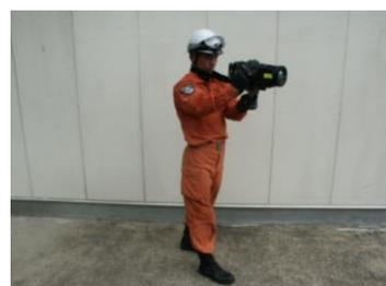
物体表面から自然放射されている赤外線をも、画像としてモニター上に表示するもので、暗闇や濃い煙の中にとり残された人を発見したり、火元や残り火を確認する装置です。
