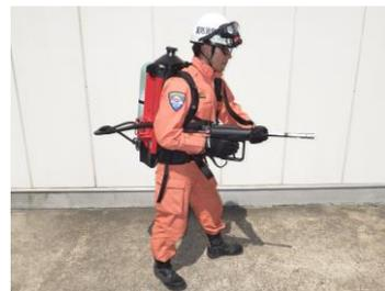
CAFS(圧縮空気泡)機能及びミスト噴霧消火機能を備えた携帯型の消火装置で、様々な種類の火災に対応しており、火災を初期の段階で一気に制圧します。
