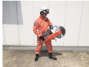
ガソリン駆動式のパワーカッターで、ブレードを交換することにより、鉄、木材、ガラス等、多様な素材を素早く切断することができる万能型器具です。
