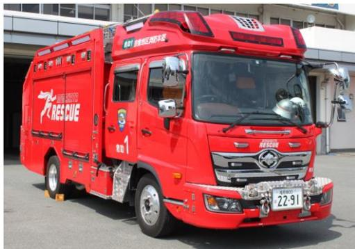
火災救急等各種の災害現場で救助活動を目的にした消防車で、空気呼吸器やレスキューカッター・照明装置など各種救助資機材を積載しています。
